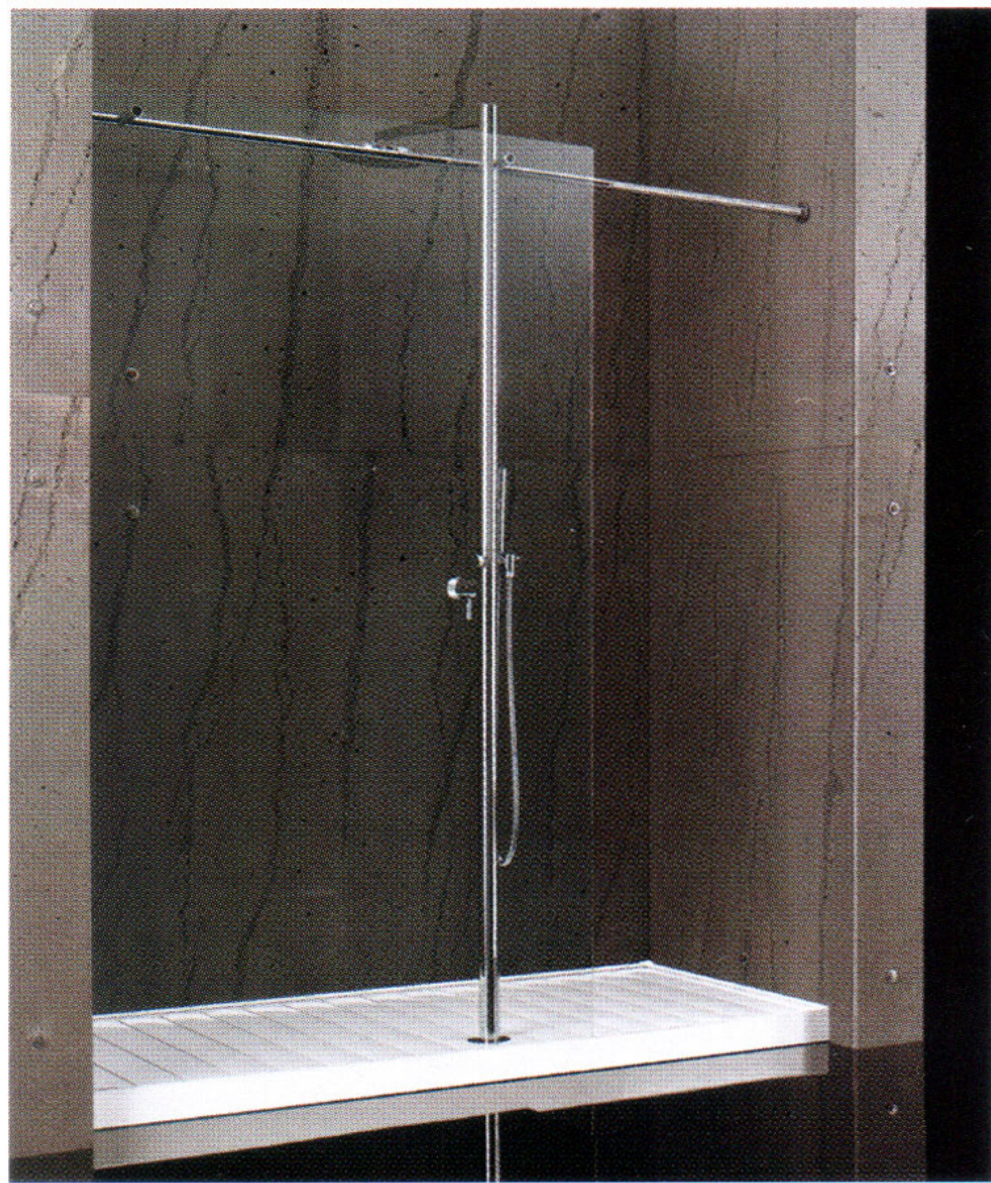
La cabina Filodoccia è dotata di un piatto doccia che contiene l'impianto di distribuzione idraulica e appoggia direttamente sul pavimento finito. Filodoccia è un elemento monoblocco che appoggia su superfici finite e sviluppa sul perimetro del piatto (a doghe in legno, alluminio bianco o nero) la costruzione modulare della cabina in cristallo (chiaro, trasparente, fumé) e con telaio in alluminio (bianco, nero antracite). Disponibile la soluzione a isola, a parete, ad angolo e in una nicchia.
