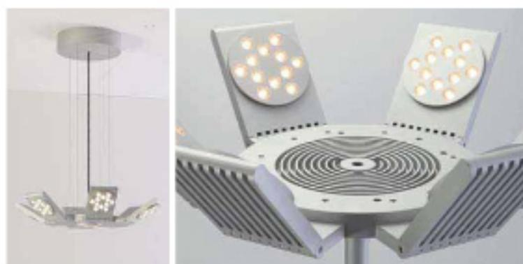
Un design essenziale e un'accurata ricerca tecnologica caratterizzano Quasar, la collezione di lampade in alluminio, disponibili nelle versioni da terra, a sospensione, a soffitto e applique. Il corpo centrale può ospitare un numero variabile di bracci, configurati a 6 o 12 LED, inclinabili fino a 45° in entrambe le direzioni oltre l'asse orizzontale, e con la possibilità di orientare il fascio luminoso sia verso l'alto che verso il basso.
